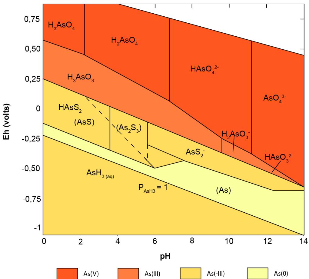
Figure Intr. 1 : Diagramme Eh-pH de l'arsenic (Wang and Mulligan, 2006) à 25°C, 101.3 kPa avec une concentration en As de  $10^{-5}$  mol L<sup>-1</sup> et une concentration en soufre de  $10^{-3}$  mol L<sup>-1</sup>
