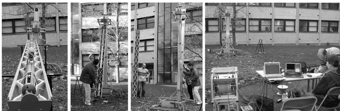
Figure 4.3 : Dispositif de mise en place de la sonde et mesure au sein des forages expérimentaux de Beaulieu (Université Rennes 1).
