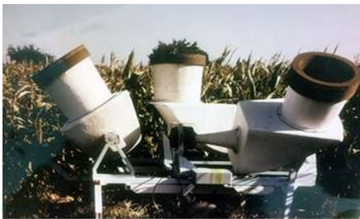
Photographie 3. Le minisodar Doppler trois antennes, 6 kHz du CRPE : les trois antennes monostatiques sont fixées sur un chariot de remorque. On remarque au premier plan à droite la chambre de compression avec un cornet exponentiel pour envoyer les impulsions sur un tronc de parabole : le faisceau central du signal d'émission-réception en sortie est parallèle aux axes des cylindres (D.R.).
