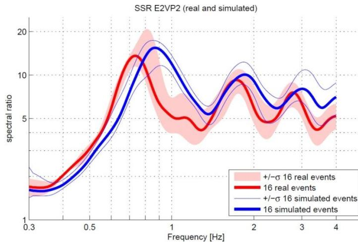
**Figure 4.** Comparaison entre rapports SSR empiriques et simulés.
