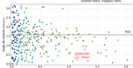
Fig. 10 variation de l'abs(mode) (valeur probable) des correspondances temporelles en fonction des coordonnées polaires des paires de stations
