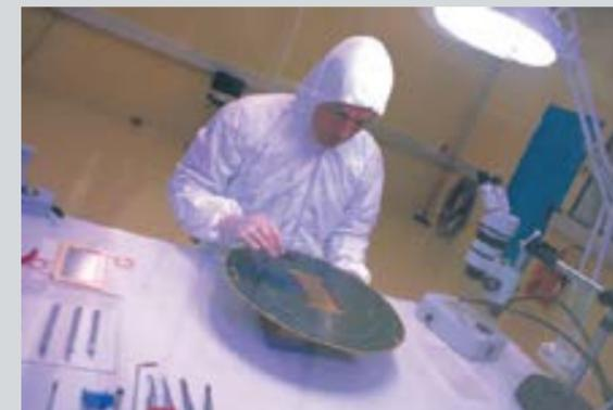
Assemblage d'un détecteur à haute résolution spatiale, type MICROMEAS, conçu pour déterminer les trajectoires des photons, utilisé notamment pour les expériences ALICE au CERN
