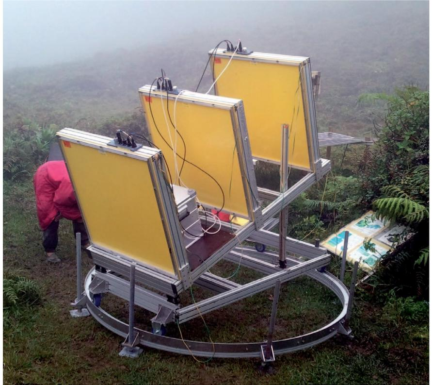
**3. Un télescope sur la Soufrière de Guadeloupe.** Les trois cadres parallèles (de couleur jaune) contiennent les matrices de détection. La matrice centrale peut être équipée de blindages d'acier de 25 mm d'épaisseur. Équipé d'un vérin et d'une base circulaire, l'instrument est facilement orientable. Lorsqu'il est en opération, il est muni de protections contre les pluies et les vents forts qui règnent sur le volcan.
