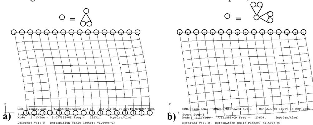
Fig. 3 : 1<sup>er</sup> mode du pion calculé sur Abaqus avec pour conditions limites : a) blocage des nœuds supérieurs en X et Y + blocage des nœuds inférieurs en Y (15131 Hz); b) idem sans blocage des nœuds inférieurs (13609 Hz)
