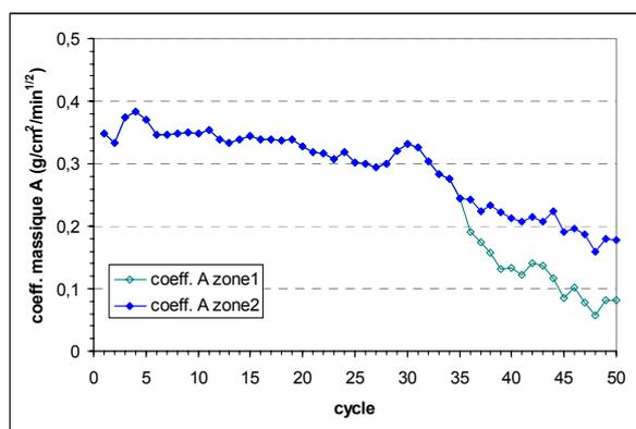
Figure 3.b : Evolution du coeff. A suivant le cyclage
